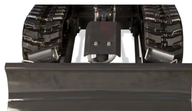
Tren de rodaje retraído : 955 mm
